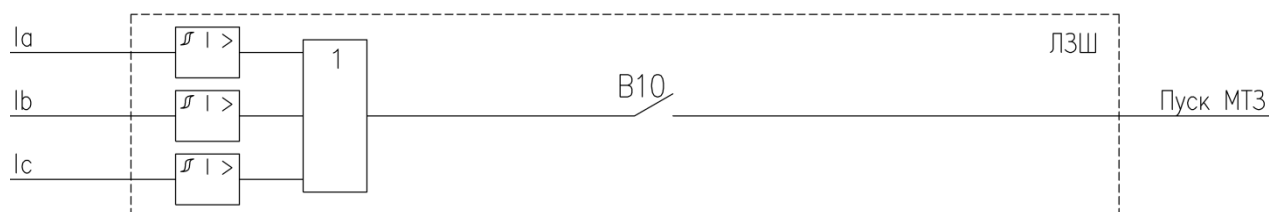
Рис. 3.7 – Функциональная схема пускового органа ЛЗШ
